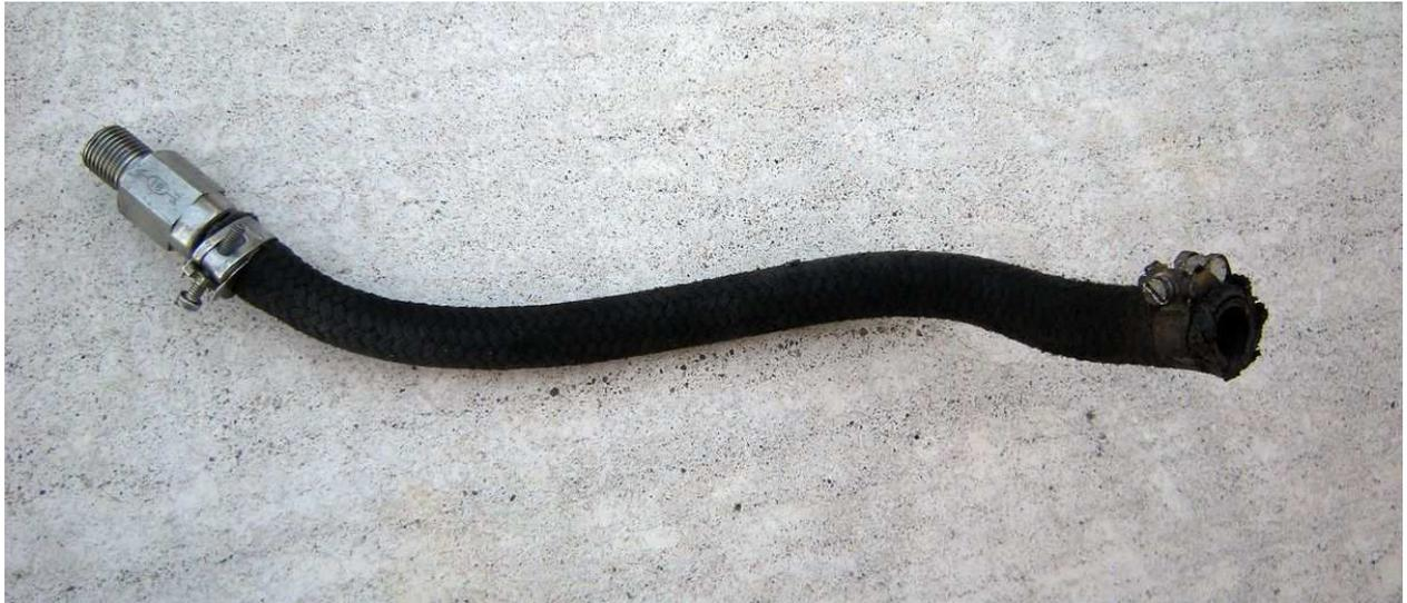
La suite est très simple : nous allons alors couper ce tuyau au 1/3 de sa longueur côté soupape métallique, vidée de sa valve, et nous allons ensuite insérer la soupape en matière plastique.
