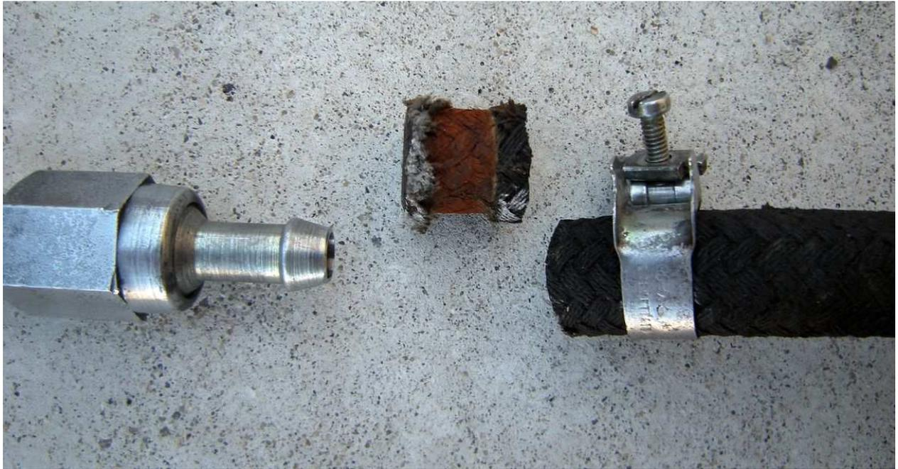
Couper alors le tuyau au 1/3 et mettre en place 2 colliers supplémentaires destinés à serrer la soupape en plastique :
