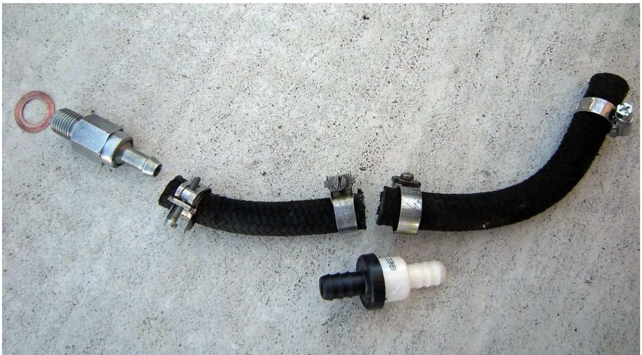
Mettre alors en place la soupape. Attention ! Un seul sens de montage fonctionne et c'est bien entendu celui qui permet de laisser passer l'air vers le plenum, l'autre sens ne le laissant pas passer, c'est normal. Pour le savoir, c'est très simple, il suffit de souffler sans la soupape. Dans un sens l'air passe, dans l'autre, c'est bloqué.
