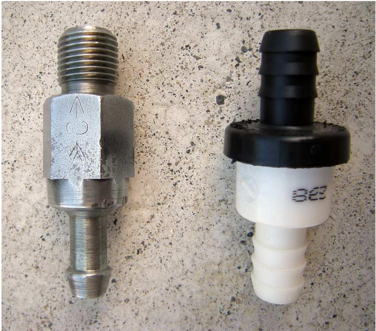
Cette soupape métallique, nous allons donc la garder mais nous allons simplement nous en servir comme connecteur du tuyau de mise au vide du Mastervac. La valve interne en caoutchouc étant devenue inutile, puisque montée sur le modèle plastique, elle doit donc être enlevée. Pour cela, une bonne solution consiste à la percer avec un foret de 7 mm montée sur une perceuse (voir photo ci-dessous).
